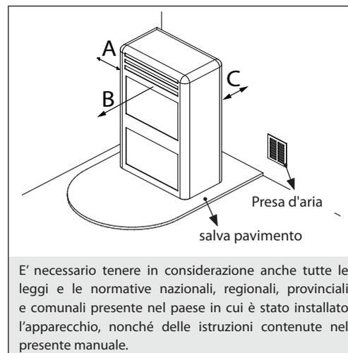
In qualsiasi condizione, compresa la presenza di cappe aspiranti e/o impianti di ventilazione forzata controllata, la differenza di pressione tra i locali di installazione del generatore e l'esterno deve risultare un valore sempre uguale o minore di 4 Pa.
