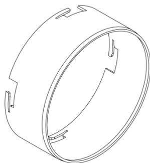
**Fig. 7. Conector metálico (boquilha) com 100 mm de diâmetro.**
