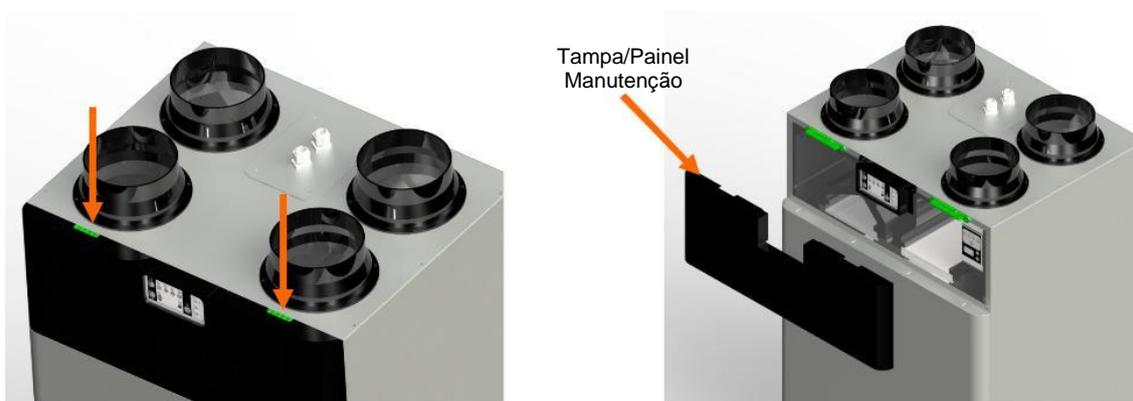
Etapa 3: Coloque os filtros de volta no lugar após a limpeza ou substituição, coloque a tampa/painel de manutenção e reajuste o tempo do alarme do filtro (consulte o ponto 4.2.1).
