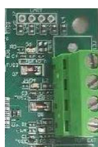
Faixa de terminal de 2 velocidades na PCB
